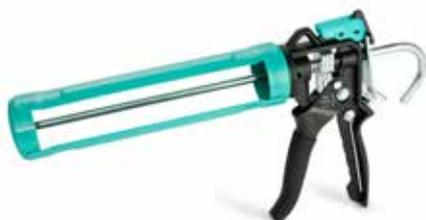
Le réglage **anti-goutte** est destiné à l'application d'acrylique et silicone qui s'écoulent rapidement. Désactivez l'**anti-goutte** pour les adhésifs de construction et polyuréthanes froids qui s'écoulent plus lentement.
